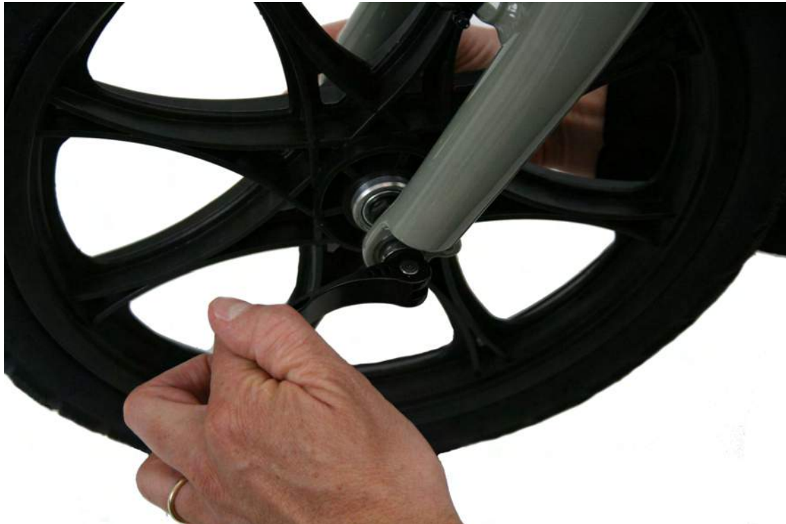
Figuur 9: Montage van het voorwiel
