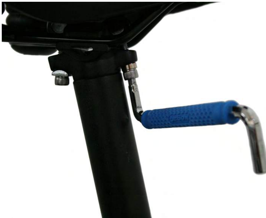
Figuur 2: Horizontale zadelverstelling
