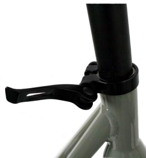
Figuur 4: Open de snelsluiters
